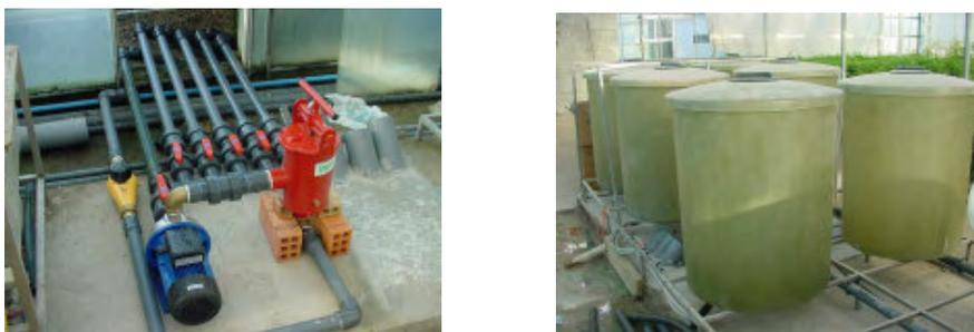
*Fig 3.- Cabeza de Fertirriego: bomba impulsora y distribuidor de fertilizantes individualizado y tanques de soluciones concentradas de los fertilizantes*
