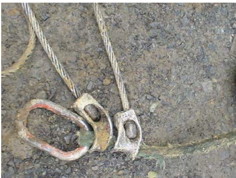
Figure 9 : Les chokers usent le câble sur sa partie terminale
