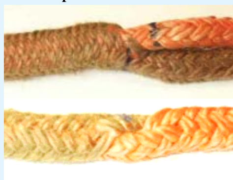
Figure 8 : Epissure bout à bout pour réparer 2 morceaux sectionnés
