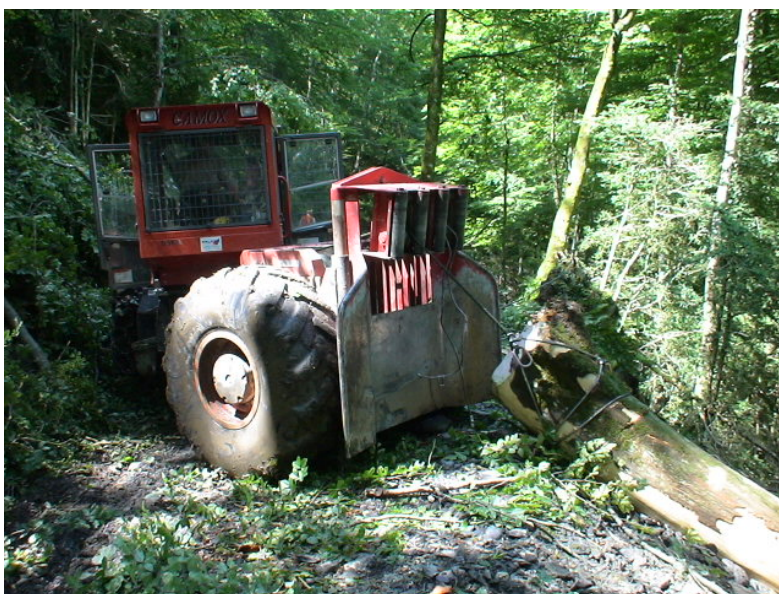
Figure 1 : Le câble synthétique représente une innovation d'importance pour le débardage au skidder.
