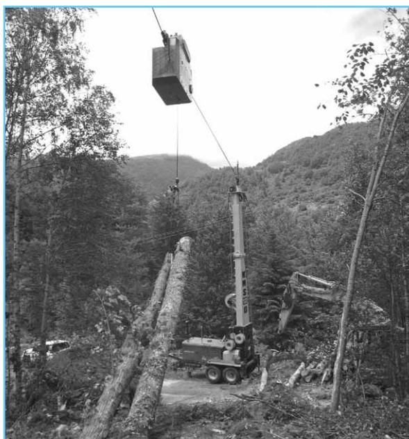
*L'utilisation du câble mât monté sur remorque suivie d'une reprise avec une pelle mécanique est bien adaptée aux conditions pyrénéennes.*
